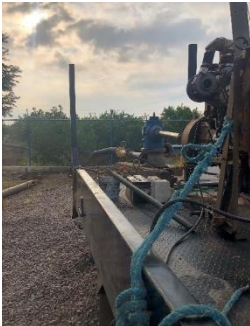
7. Aforo de pozo por un lapso de 48 horas con bomba de 6" a 120 metros de profundidad.
