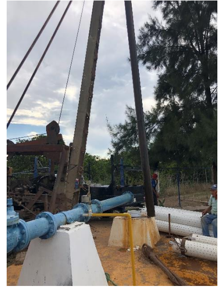
7. Aforo de pozo por un lapso de 48 horas con bomba de 6" a 120 metros de profundidad.
